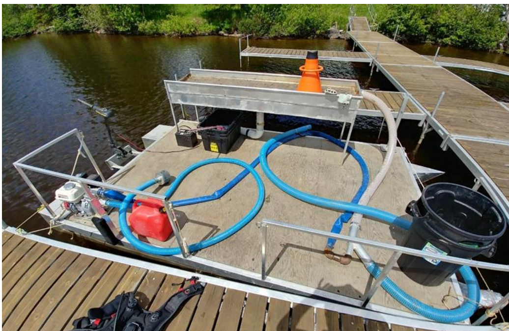
Figure 23. Exemple de système de remontée par succion (SRS).
