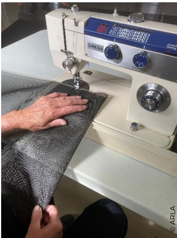
Figure 10. Couture de l'ourlet aux extrémités de la toile pour insérer les tiges de métal avec rondelles aux bouts.
