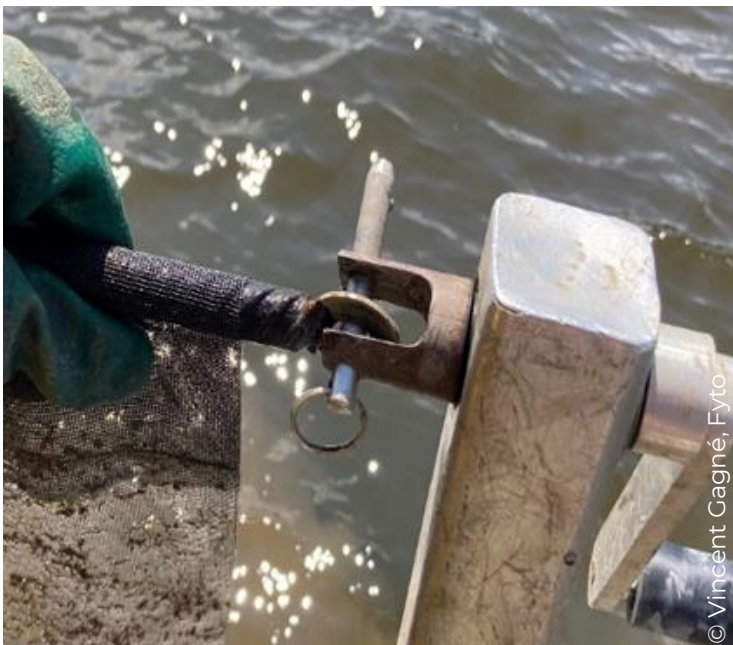
Figure 35. Les rondelles de métal sur les tiges de métal aux extrémités des toiles servent également à la fixer à la manivelle pour faciliter l'enroulement.
