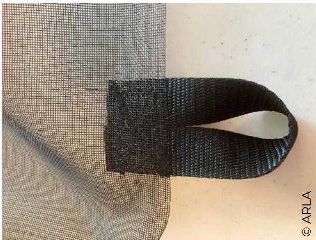
Figure 11. Boucles cousues au tiers et aux deux tiers de la toile.
