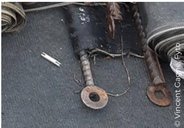
Figure 6. Tiges de métal munies de rondelles aux extrémités.
