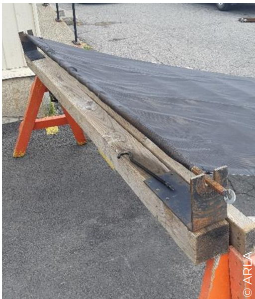
Figure 13. Insertion de la tige dans les supports de métal.
