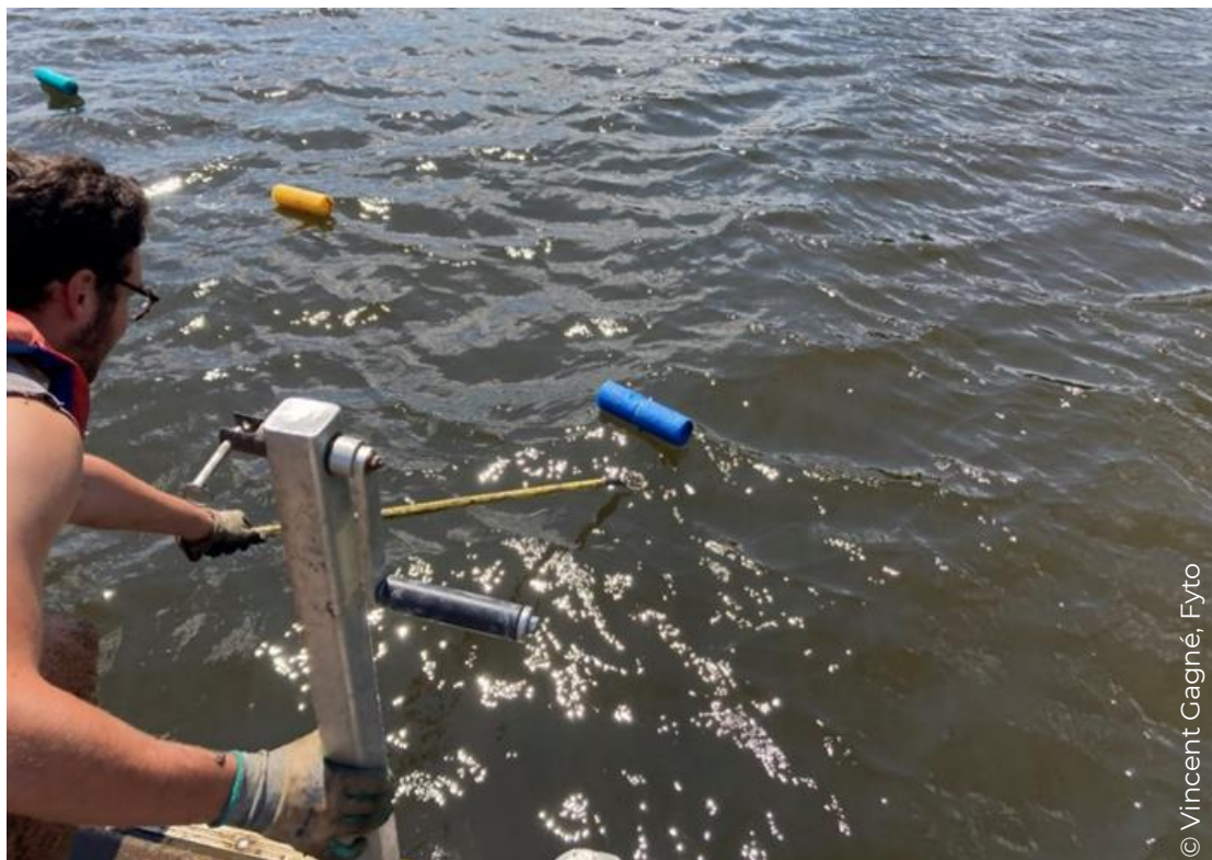
Figure 31. Récupération de la bouée de toile avec le crochet au bout d'un bâton.
