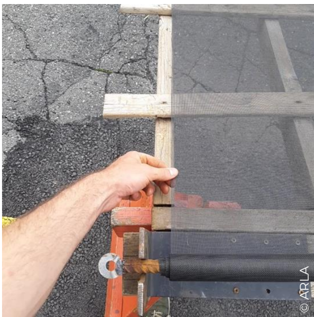
Figure 15. Enroulement de la toile en gardant la tension.
